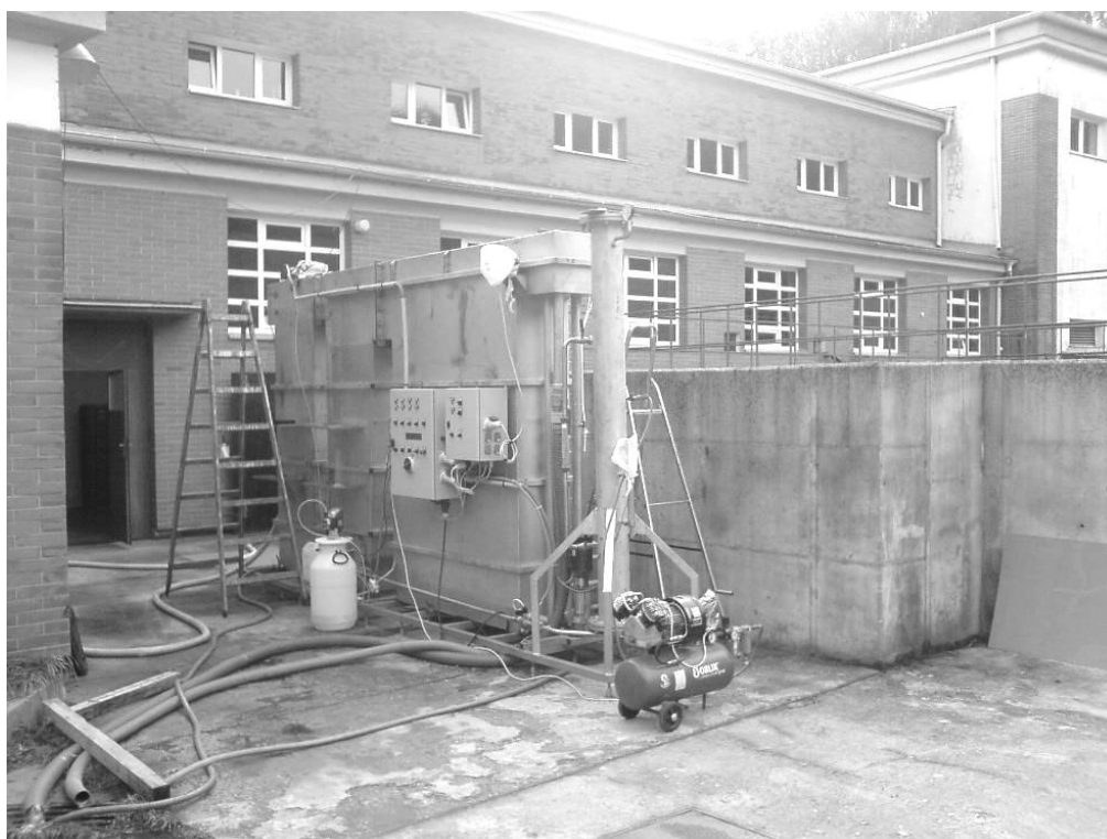
Obr. 1. Umístění modelu flotace vedle reakční nádrže na ÚV Meziboří
