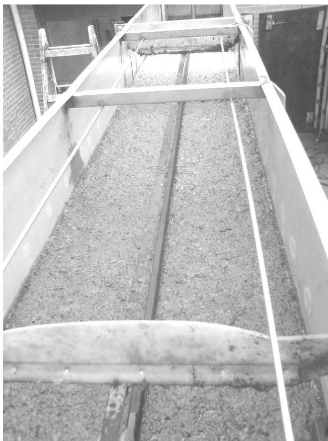
Obr. 16. Hladina separační zóny s kalem při provozu modelu flotace na ÚV Meziboří
