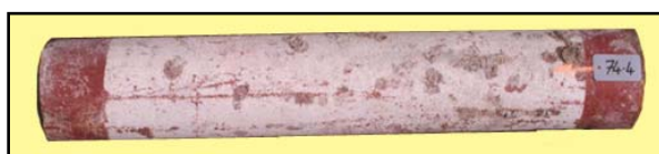
Obr. 13 Vzorek (400 g/m 2 Zn/Al + epoxid)
