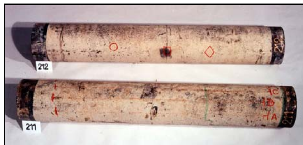
Obr. 10 Vzorky (200 g/m 2 Zn + bitumen)
