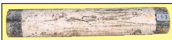
Obr. 12 Vzorek (200 g/m 2 Zn + bitumen)
