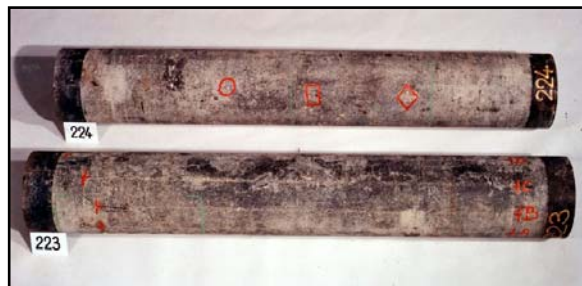
Obr. 11 Vzorky (400 g/m 2 Zn/Al + bitumen)
