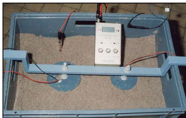
Obr. 2 Instalace vzorků v testovací nádobě
