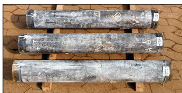
Obr. 9 Vzorky 400 \text{g}/\text{m}^2 Zn/Al + bitumen
