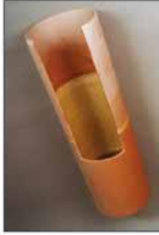
SANACE LOKÁLNÍCH PORUCH POTRUBÍ TECHNOLOGIÍ KAWO - LOCAL
