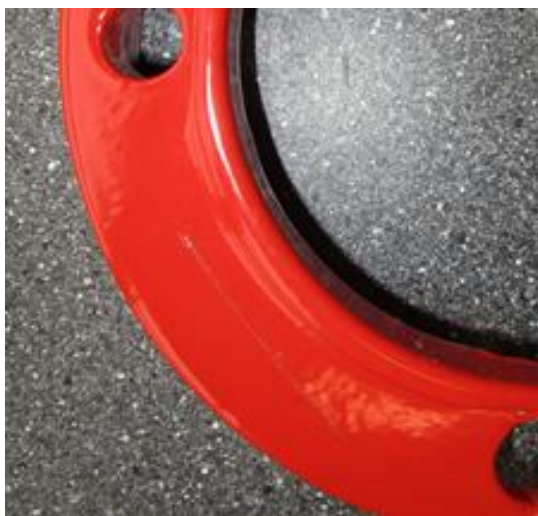
Obr. 1 Povlak hydrantového dílce po korozní zkoušce v solné komoře v délce trvání 2000 hodin
