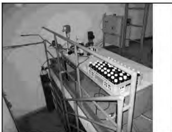
Obr. 2: Pokusná ozonizační souprava
