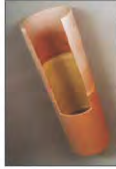
SANACE LOKÁLNÍCH PORUCH POTRUBÍ TECHNOLOGIÍ KAWO - LOCAL
