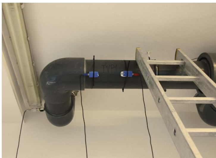
Obr. 4 Sací potrubí čerpadla s množstvím směrových lomů a osazení sond ultrazvukového průtokoměru a snímače tlaku.
