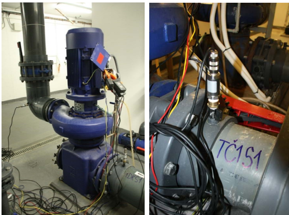
Obr. 5 Příklad měření dopravní výšky a příkonu čerpadla pro vyhodnocení účinnosti
