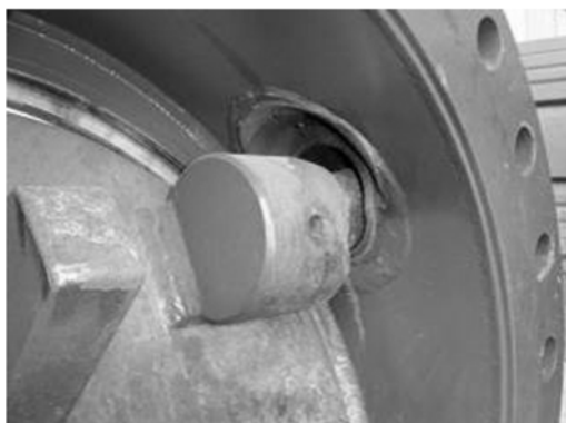
Obr. 2. Poškozené čepy kmitáním disku
