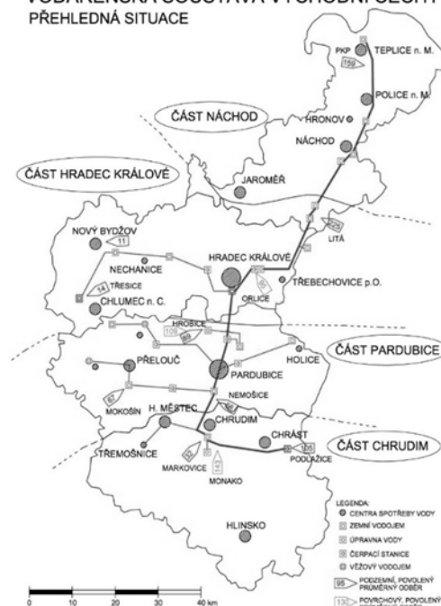
Obr. 1 Schéma Vodárenské soustavy východní Čechy
