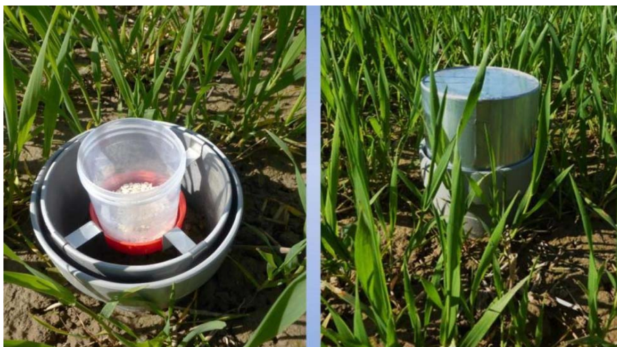
Obr. 6 a 7 Měření půdní respirace. Fotografie otevřené a hermeticky uzavřené kapsle s natrokalcitem.
