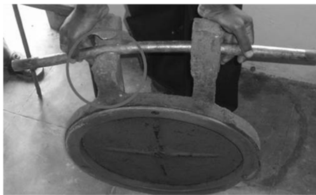
Obr. 3 Poškozený závěs disku vlivem kmitání
