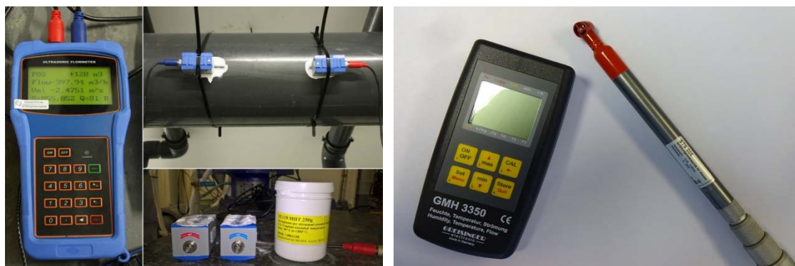
Obr. 1 Přenosný ultrazvukový průtokoměr a přístroj GMH 3350 se sondou STS 005
