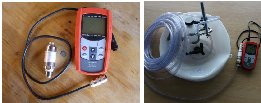
Obr. 2 Tlakoměr GMH 5155 s tlakovou sondou MSD -1/3 BRE a souprava pro měření podtlaků na sacích prvcích
