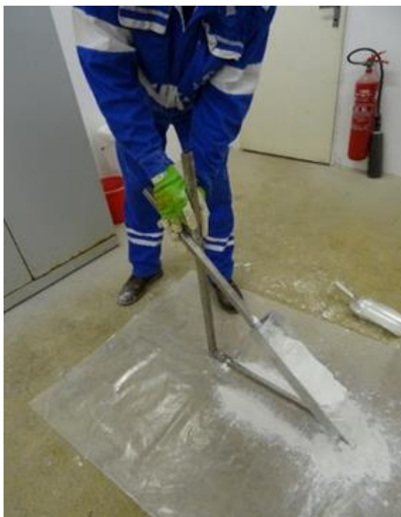
Obr. 1 Stanovení úhlu skluzu vápenného hydrátu na vlastní aparatuře
