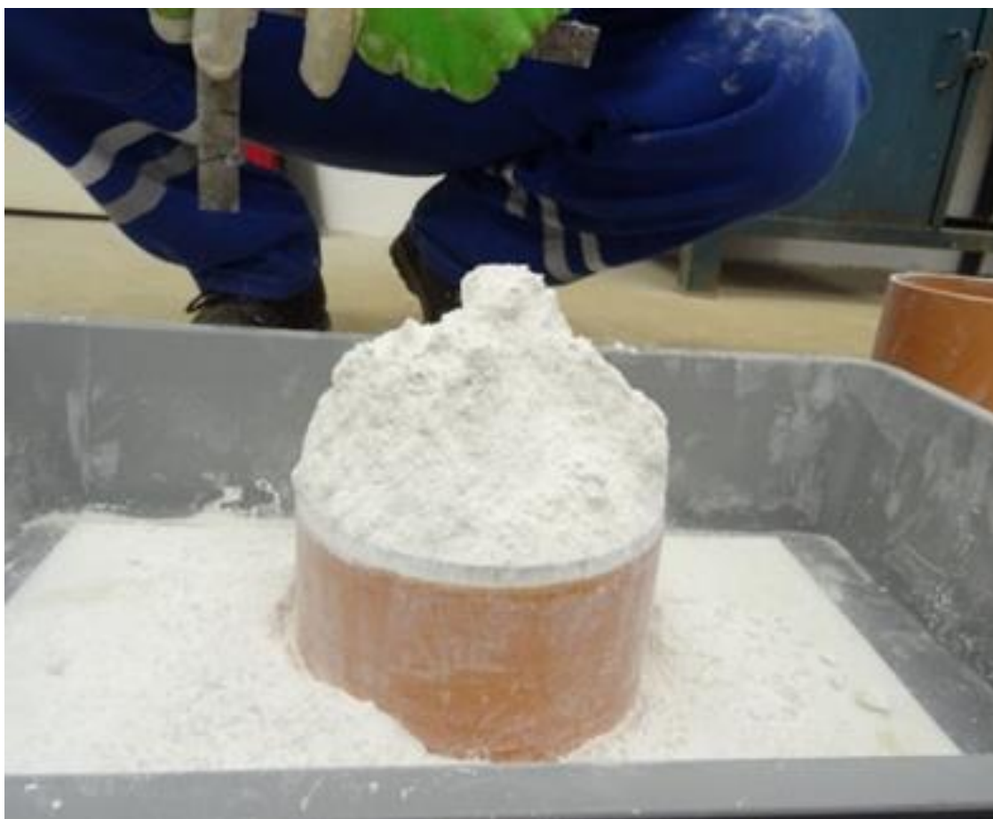
Obr. 2 Stanovení úhlu navrstvení vápenného hydrátu na vlastní aparatuře; kužel zbylého vzorku po odstranění horního válce
