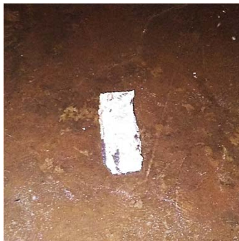
Obr. 12 Kus betonu o rozměrech cca 150 x 300 mm na podlaze akumulační nádrže
