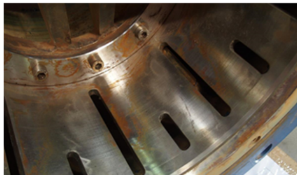
Obr. 12 Štěrbínový regulační válec typu SZ po 65.000 cyklech (PVK a.s.)
