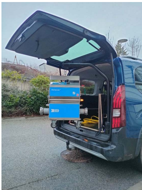
Obr. 3 Jeřábek pro manipulaci se strojem Astacus; stroj při práci v terénu (1. generace)
