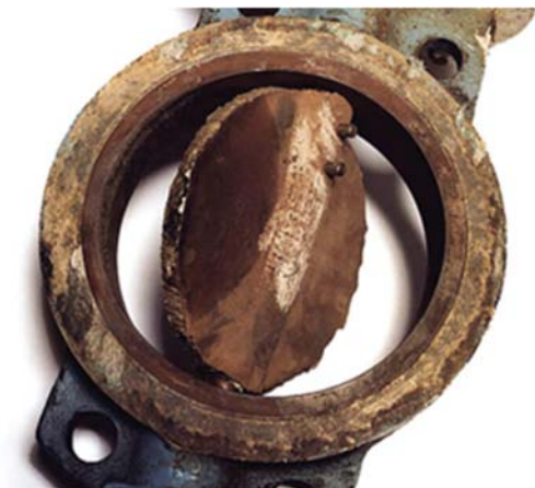
Obr. 7 Poškozený disk centrické klapky
