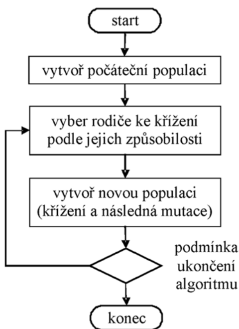
Obr. 2 Vývojový diagram genetického algoritmu [8]
