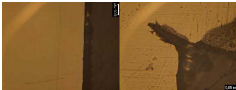
Obr. 6 Oblast pod hladinou, bez známek koroze. Vpravo korozní důlek v okolí svaru.
