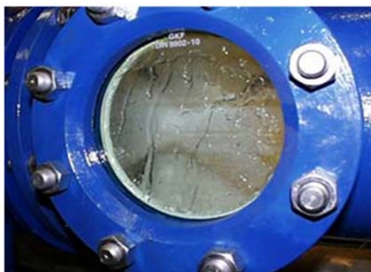
Obr. 10 Usměrněný proud kapaliny na výstupu z ventilu nezatěžuje potrubí
