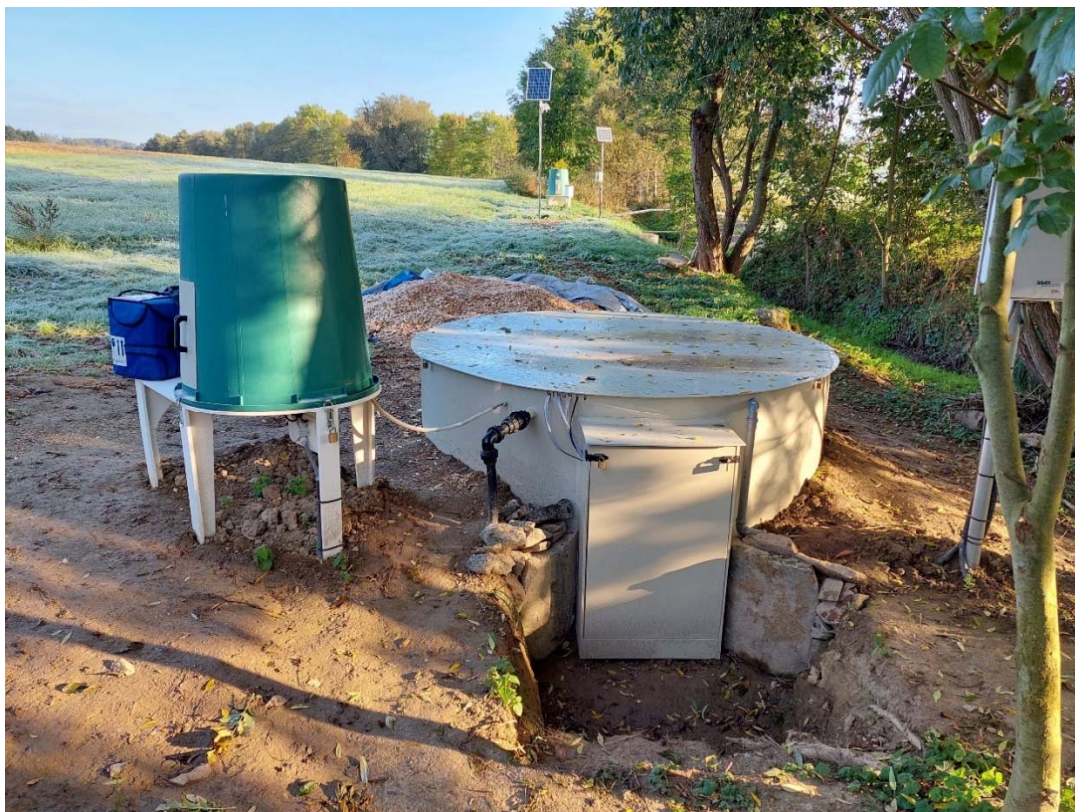
Obr. 4 Poloproduční jednotka štěpkového denitrifikačního bioreaktoru určená k souběžnému odstraňování dusičnanů a pesticidů.
