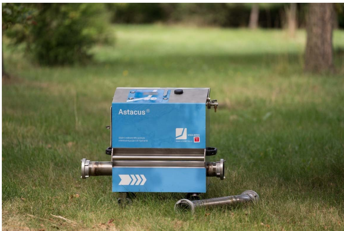
Obr. 2 Robot Astacus – stroj pro měření a řízené proplachování potrubí (2. generace)
