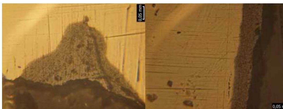
Obr. 7 Oblast pod hladinou - korozní důlek, vyplněn korozními produkty (vlevo) a korozní film (vpravo)
