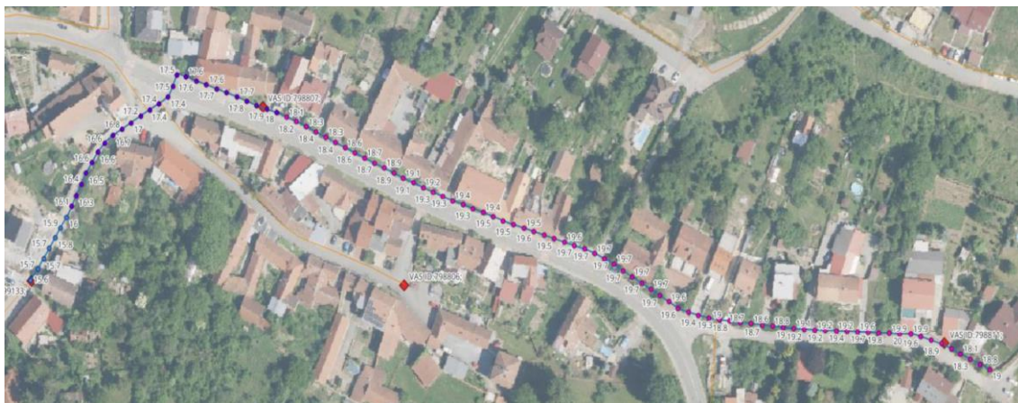
Obr. 5 Vizualizace měřené teploty vody do podkladní mapy. Voda na obrázku proudí z VDJ zleva doprava. Proplachovaný hydrant s osazeným strojem Astacus je na obrázku zcela vpravo. Průběh teploty vody tohoto úseku je patrný z grafu na Obr. 4.
