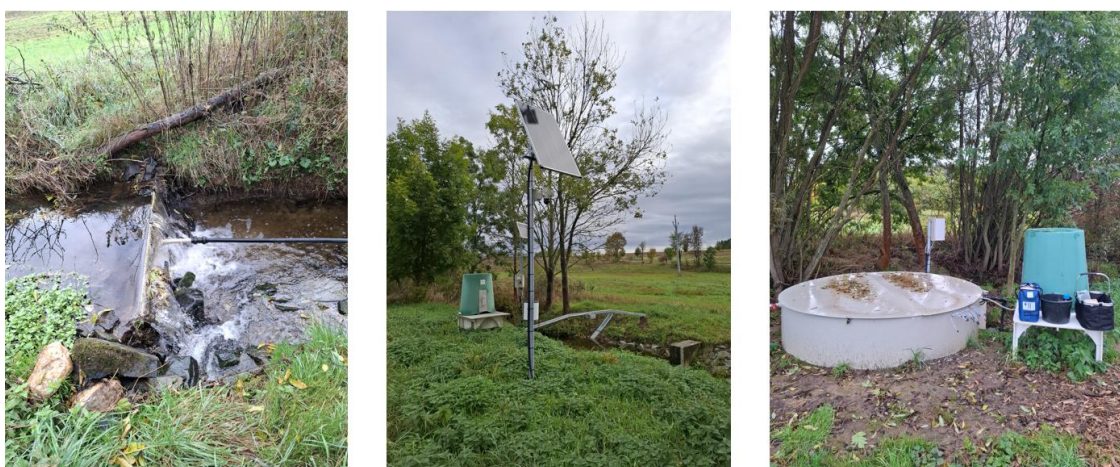
Obr. 1: Poloprovozní jednotka štěpkového denitrifikačního bioreaktoru určená k souběžnému odstraňování dusičnanů a pesticidů.
