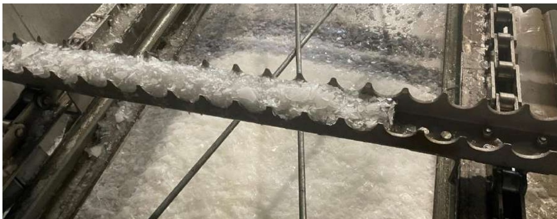
Obrázek 2 Příprava ledu ve stacionárním výrobě (foto OVAK a.s.)
