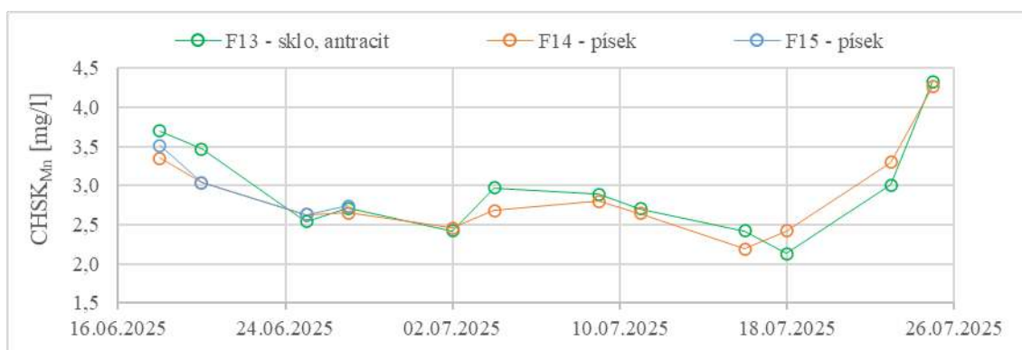
Obr. 3 Srovnání koncentrace CHSK Mn ve filtrátu z porovnávaných filtrů
