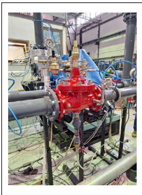
Obrázek 2: Měřicí trať s pojistným ventilem Cla-val DN 100 / PN 16 typ 52-G1E-03 se spodním stavoznakem
