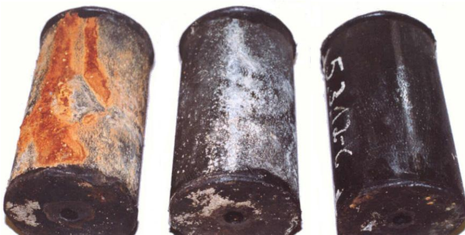
Obr. 3. Vyzvednuté vzorky po mnoha letech v agresivním půdním prostředí s kolísající hladinou podzemní mořské vody. Zleva: bez ochrany, žárové zinkování, žárové zinkování slitinou zinku s hliníkem (prodloužená aktivní ochrana a rozsah použití)
