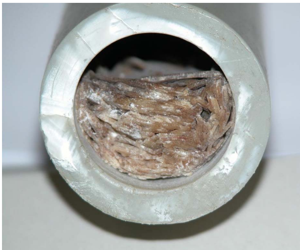
Obr. 2 Krystalická usazenina v potrubí z umělé hmoty
