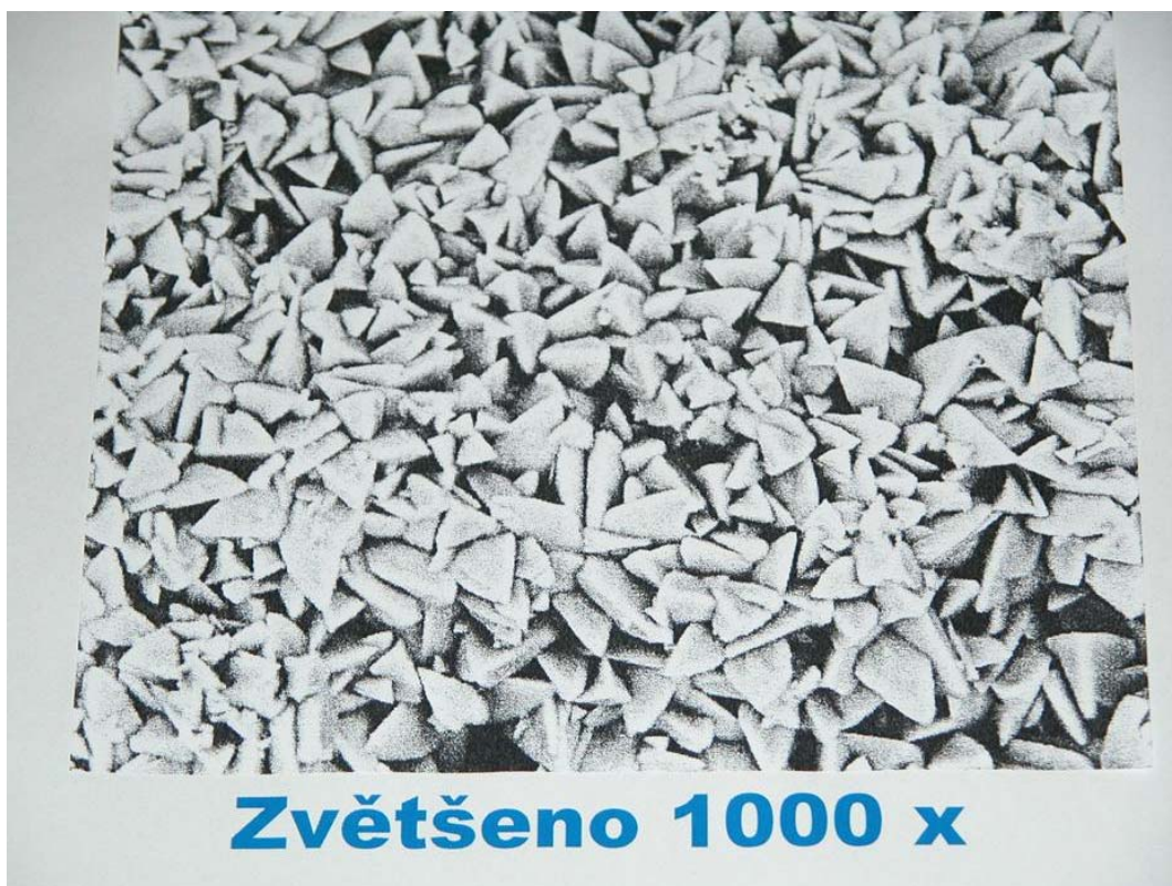
Obr. 1 Vzorek „písku“ odebraný z vodovodní baterie
