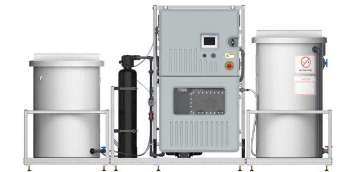
Obr. 2 Ukázka sestavy pro výrobu směsných oxidantů s elektrolyzérem Aquion MIOX Vault s kapacitou 6,8 – 13,4 – 20,4 – 27,2 kg ekvivalentu volného aktivního chloru za den.
