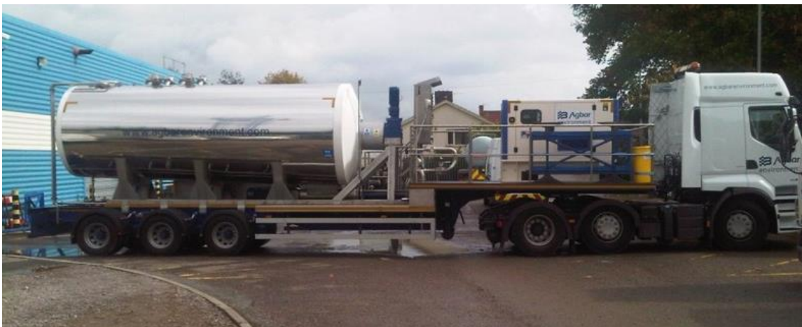
Mobilní jednotka na dodávku ledové tříště je umístěná na kamionu.
