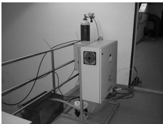
Obr. 3: Úpravna vody Tlumačov – ozonizační pokus – pokusná ozonizační sestava s ozonizátorem WEDECO GSO 10
