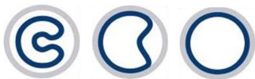
Obr. 6 Jednotlivé kroky instalace Compact Pipe
