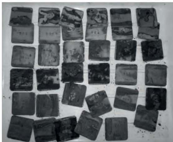
Obr. 4 Kupony před mořením v kyselině chlorovodíkové
