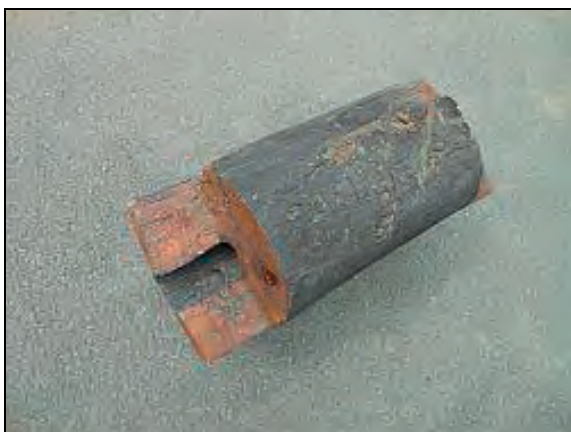
Obr. 1: Výřez z dřevěného vrtaného potrubí
