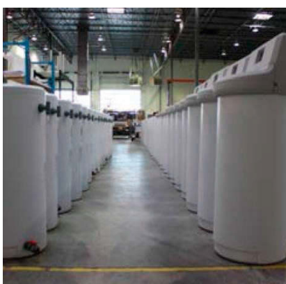
Obr. 7 Aquion MIOX ZUNI čekají expedici (0,45 a 0,9 kg/d chloru)
