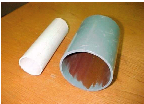
Obr. 3 Porovnání tvorby biofilmu – vlevo dezinfekce za použití směsných oxidantů, vpravo při použití chlornanu sodného
