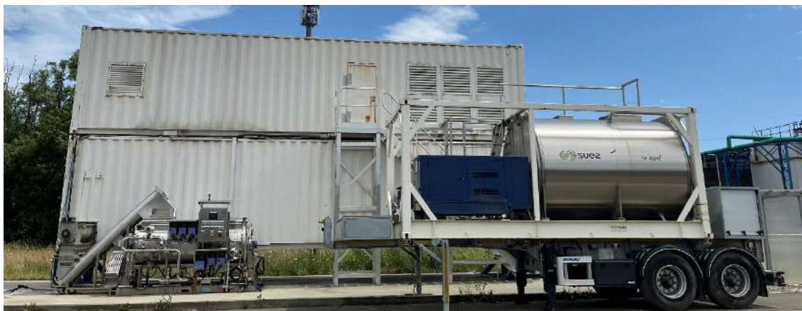
Obrázek 1 Stationární výrobce ledu a přepravní nádrž (mobilní jednotka) pro dopravu ledu (foto OVAK a.s.)
