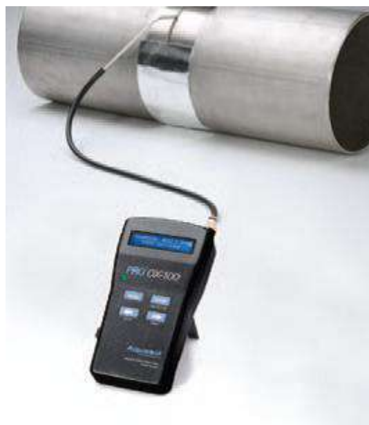
Obr. 3 Měření obsahu kyslíku oxymetrem
