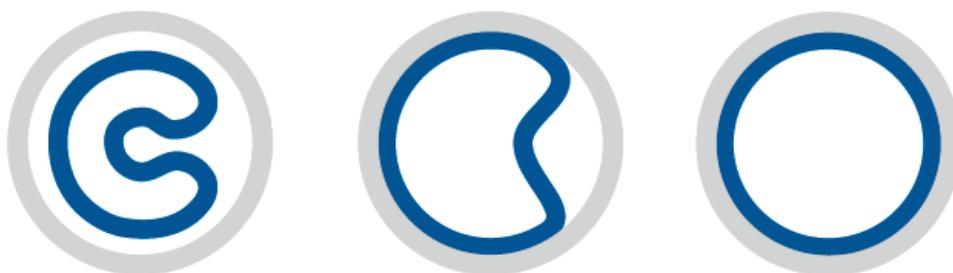
V první fázi se zatahuje předtvarované potrubí z výroby do již připraveného úseku. Tento úsek musí být řádně vyčištěn, zmonitorován a protažen kalibračním nástrojem. V druhé fázi dochází k prohřívání PE potrubí v celé délce úseku pomocí páry a postupně se PE trubka díky tvarové paměti vrací zpět do kruhového tvaru. Close-Fit efekt vzniká v poslední části instalace, kdy PE trubka těsně dosedá k vnitřní straně stávajícího potrubí.
