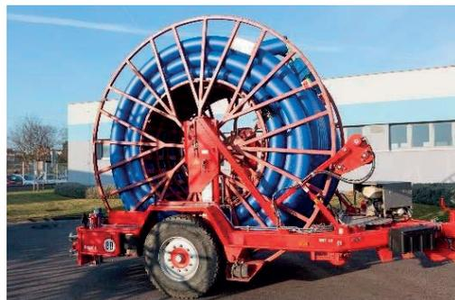
Compact Pipe je dodáván navinutý na bubnech, tyto bubny se upevní do vozíku a potrubí se odvíjí přímo ke vstupní jámě. Parní jednotka – „srdce“ reverzního procesu – dodává páru pro reverzní proces a obsahuje zařízení pro řízení instalace. Stlačený vzduch je dodáván do potrubí Compact Pipe prostřednictvím parní jednotky. Dále jsou pro instalaci Compact Pipe zapotřebí různé standardní nástroje, zařízení a doplňky, např. naviják, kompresor, svařovací nástroje a expandér potrubí.
