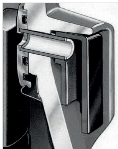
*Obr. 1 Detail odvodnění s trubkou přes stěnu tělesa*
