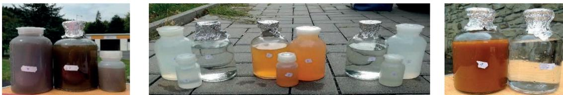
*Obr. 1* Vzorkovnice s odebranou vodou z vodovodu se sedimentem a s vodou po provedení proplachu pro mikrobiologický, chemický a hydrobiologický rozbor.
