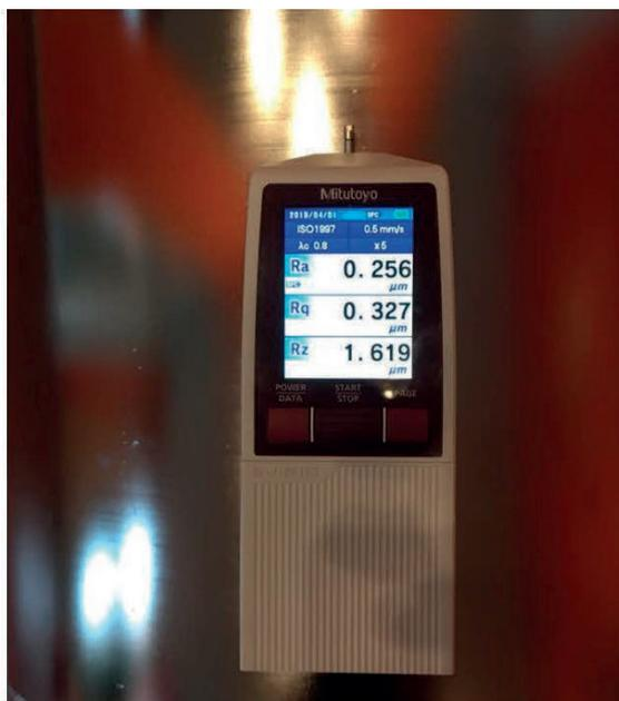
*Obr. 1 Výrobek ošetřený elektrolytickým leštěním (vlevo), měření drsnosti (vpravo)*
