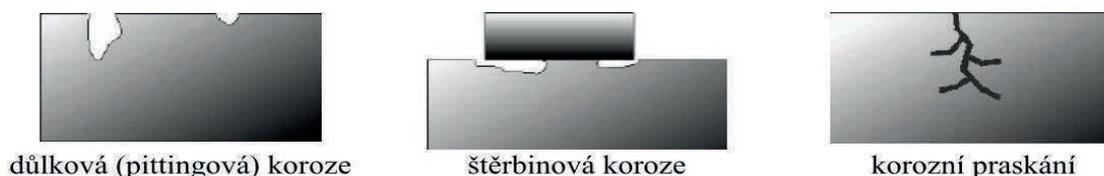
*Obr.1: Lokální formy korozního napadení korozivzdorných ocelí*
